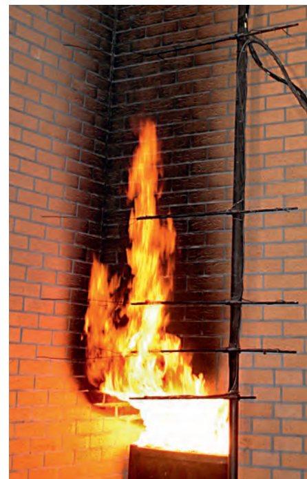
Realistisches Szenario eines Wohnungsvollbrandes während des Großbrandversuchs
